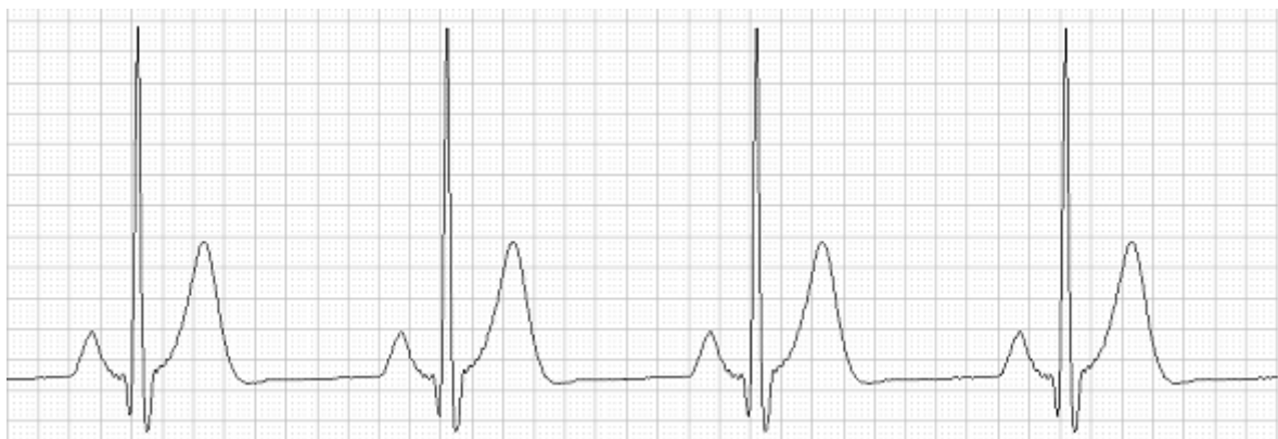
Figura 73. Ejemplo de la misma señal con filtro de línea para 50Hz
